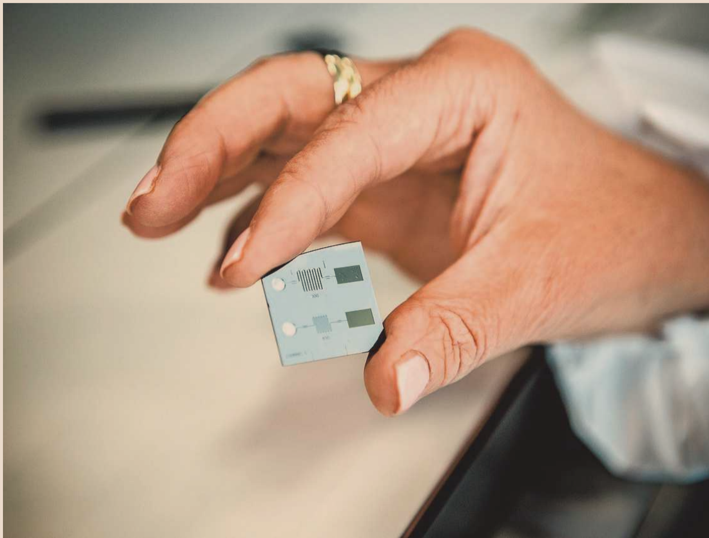
Een chip voor de bloedtest. Het druppeltje bloed komt in het bolletje en vloeit verder in haarfijne kanaaltjes en piepkleine kamertjes.
